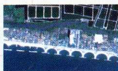
กองหินป้องกันคลื่น (Offshore breakwater) บริเวณหาดแสงจันทร์ จังหวัดระยอง
